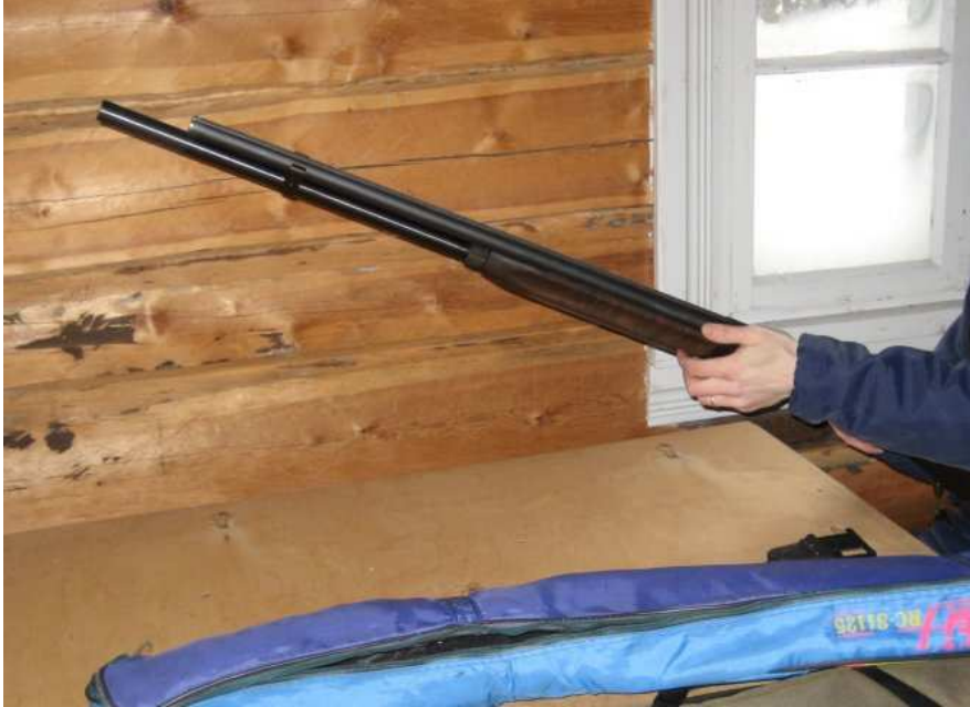
"Riittävän pitkä" putkimakasiini.
